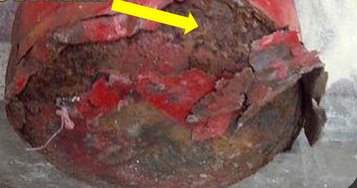
DAÑO EN EXTINTOR POR CORROSION EN CILINDRO DE METAL
